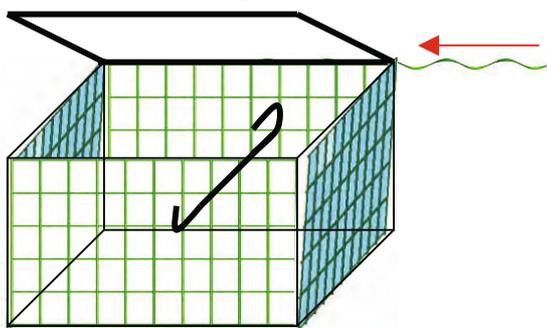
9. Verschließen Sie den Deckel mit den letzten 3 Verbindungsspiralen.
