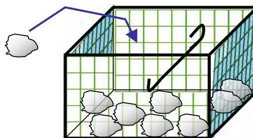
8. Befestigen Sie das Deckelement mit einer Verbindungsspirale.
