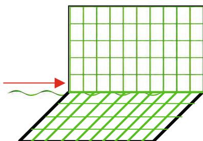
3. Befestigen Sie ein weiteres Seitenelement mit Hilfe von 2 Spiralen an den ersten beiden Elementen.
