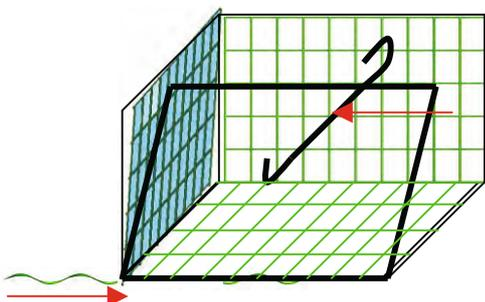
5. Befestigen Sie das 4. Element mit einer Verbindungsspirale.
