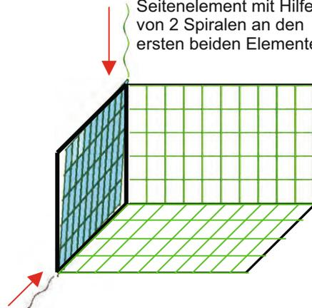
4. Verbinden Sie das 4. Seitenelement mit dem Bodenelement und hängen die Distanzhalter ein.
